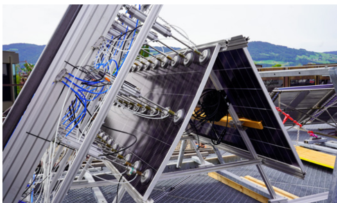
Auf dem Solardach am OST-Campus Rapperswil-Jona musste die Solartanne einiges aushalten: Das SPF prüfte sie mit eigens entwickelten Belastungs- und Alterungstests.
