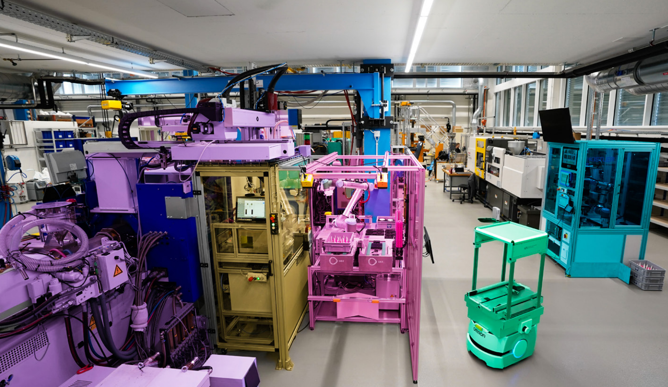
Das KI-Trainingszentrum für autonome Qualitätssicherung an der OST. violett: Spritzgussmaschine; gelb: QR-Lasermarkierung; pink: Handling-Roboter; grün: Logistik-Roboter; blau: Qualitäts-Messzelle
