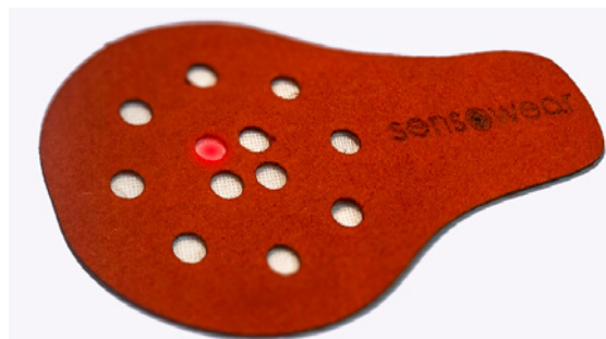
Solche Sensoren messen den Druck und liefern die Daten zur Auswertung.
