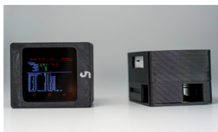
Die am IET entwickelten Aerosolsensoren messen Partikelgrösse und -konzentration sowie Raumtemperatur und Luftfeuchtigkeit. Die Daten werden laufend an einen Server gesendet, wo diese ausgewertet und anschliessend visualisiert werden.
